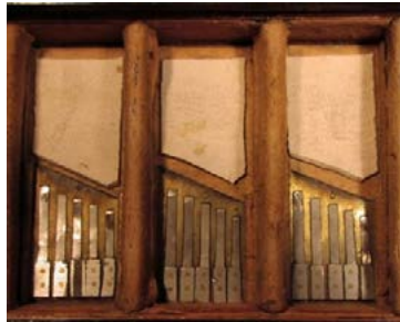
Fig.3 - As palhetas livres no interior de um acordeon. A "alma" do instrumento.
